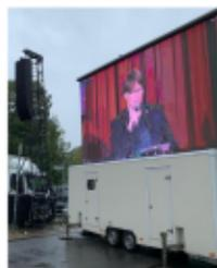
mobile LED Videoleinwand auf Anhänger. Schnell aufgebaut innerhalb einer Stunde. Benötigt mindestens 1x 16A CEE Anschluss.
